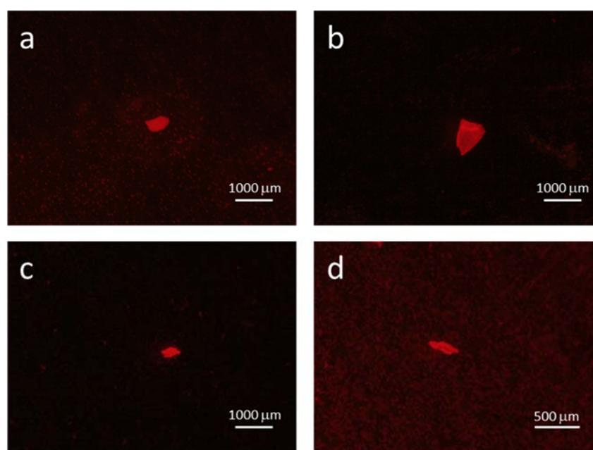
Figure 1 : illustrations des particules trouvées et identifiées en tant que microplastique ; (a) poisson [ID 162] (b) poisson [ID 280] (c) poisson [ID 281] (d) Rhône Chancy 300 $\mu\text{m}$ . Images obtenues par microscopie de fluorescence ( $\lambda_{\text{ex}}$ . 565 nm -  $\lambda_{\text{em}}$ . 630 nm).
