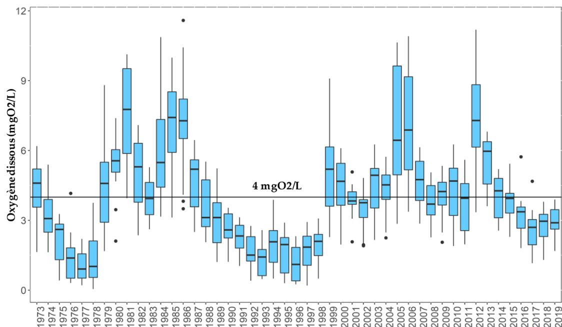
\* Mesure de la concentration en oxygène dissous effectuée en laboratoire selon la méthode de Winkler à des profondeurs définies
