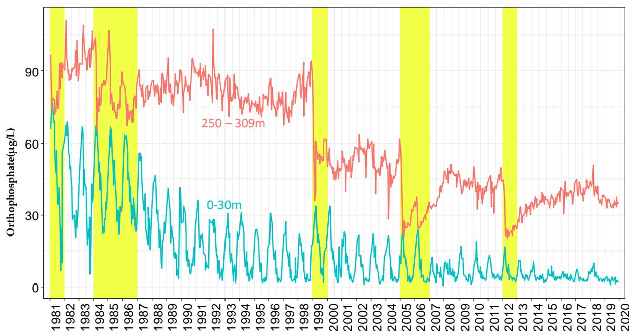
Figure 16 : Concentration moyenne pondérée en phosphore réactif soluble ( $P-PO_4^{3-}$ ) dans la couche 0 - 30 m et les couches profondes (250 - 309m), Léman - Grand Lac (SHL2) de 1981 à 2019. Les barres en jaune représentent les brassages complets
