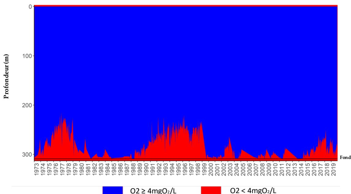
\* Mesure de la concentration en oxygène dissous effectuée en laboratoire selon la méthode de Winkler à des profondeurs définies
