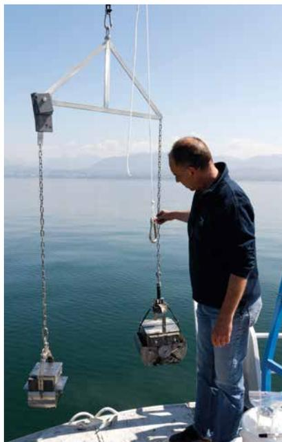
Echantillonnage des sédiments de surface à l'aide d'une benne Ekman.
