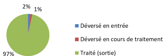
Figure 4 : Répartition des volumes traités et déversés par les STEP du territoire de la CIPEL en 2017
