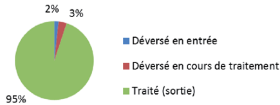
Figure 4 : Répartition des volumes traités et déversés par les STEP du territoire de la CIPEL en 2015
